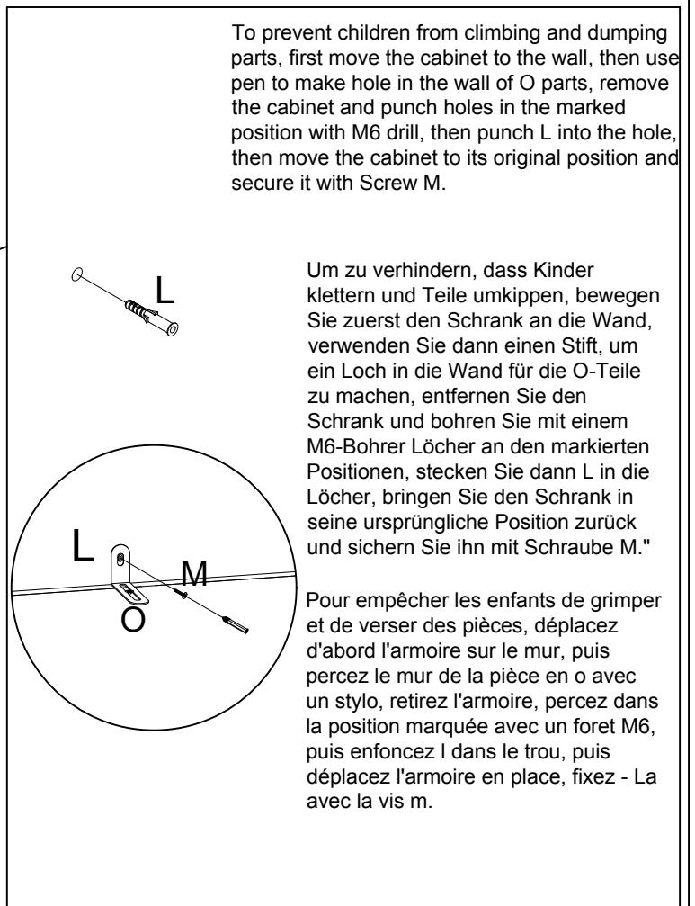
Um zu verhindern, dass Kinder klettern und Teile umkippen, bewegen Sie zuerst den Schrank an die Wand, verwenden Sie dann einen Stift, um ein Loch in die Wand für die O-Teile zu machen, entfernen Sie den Schrank und bohren Sie mit einem M6-Bohrer Löcher an den markierten Positionen, stecken Sie dann L in die Löcher, bringen Sie den Schrank in seine ursprüngliche Position zurück und sichern Sie ihn mit Schraube M."
