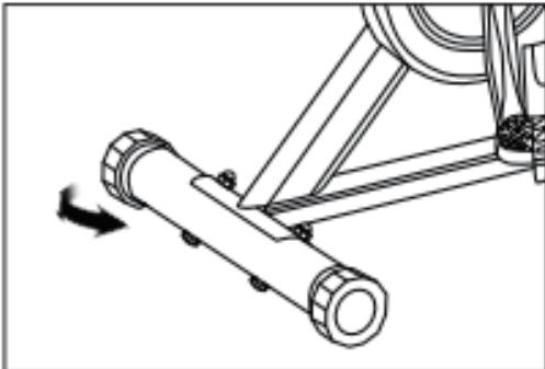
Se la bici oscilla, regolare i due tappi sul tubo del piede posteriore per regolarne il bilanciamento.
