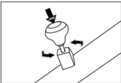
Se si desidera frenare con all'improvviso, è necessario premere la manopola di regolazione della resistenza per evitare affaticamento muscolare o altre lesioni.
